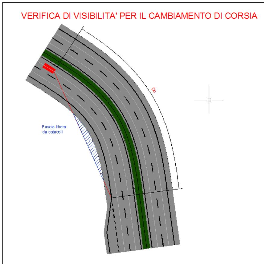
Figura 17 - Schema per l'esecuzione della verifica di visibilità per il cambiamento di corsia.
