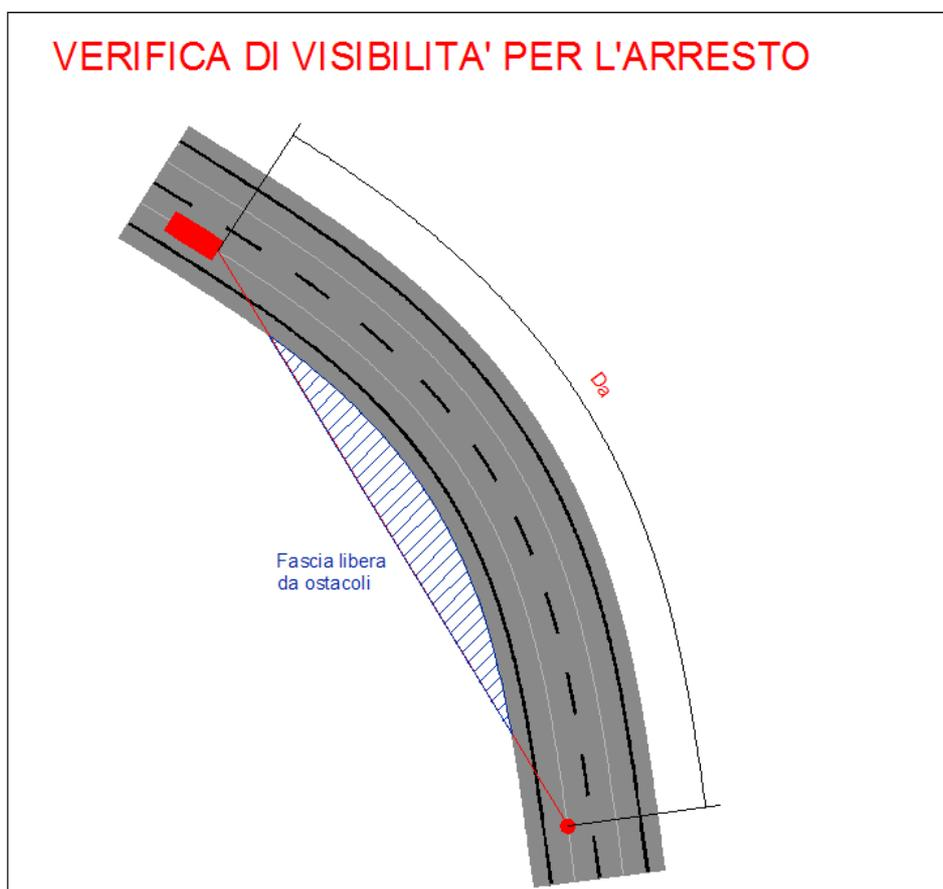
**Figura 15 - Schema per l'esecuzione della verifica di visibilità per l'arresto.**
