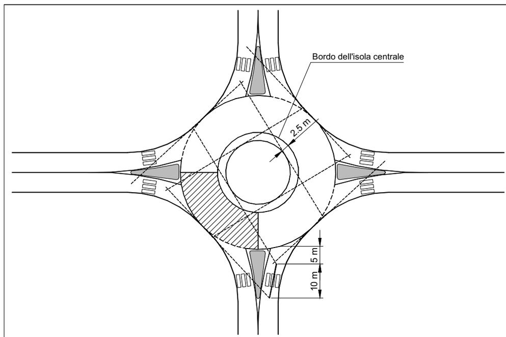
**Figura 12:** Campi di visibilità in incrocio a rotatoria
